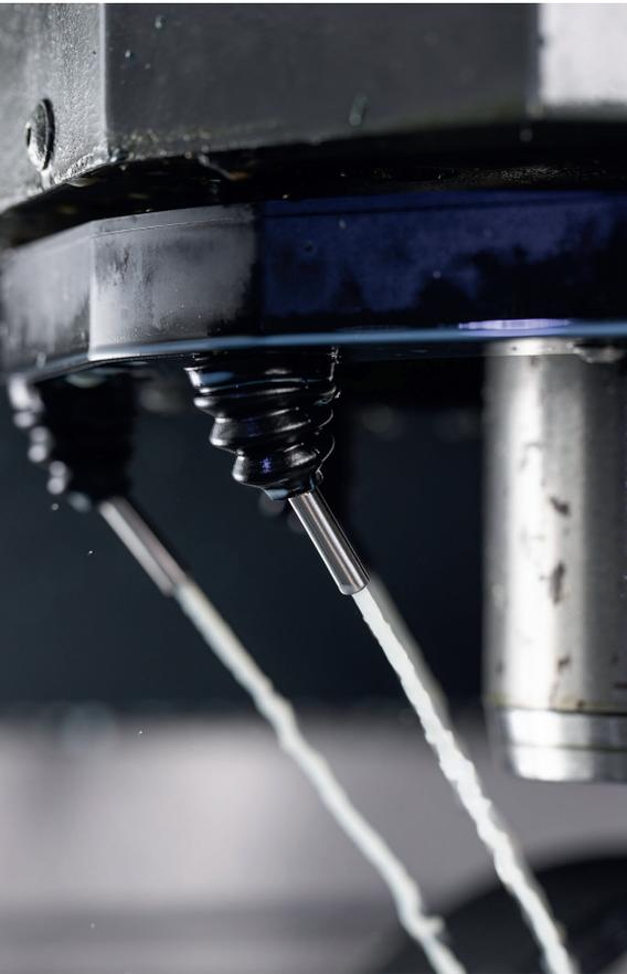
4 Die Kühlmitteldüsen erzeugen einen Fluiddruck von maximal 15 bar
